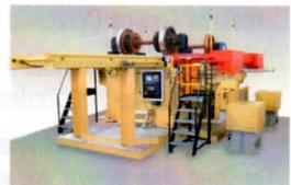
U 2000 - 400, die neu entwickelte Unterflur Radsatz Drehmaschine !
